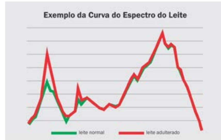
O leite cru natural tem um espectro particular - uma única identidade. Se a amostra está, de alguma forma, diferente do leite normal, será detectada imediatamente na triagem do espectro, conforme mostra a imagem. A linha vermelha representa uma amostra adulterada, enquanto a verde uma amostra normal
