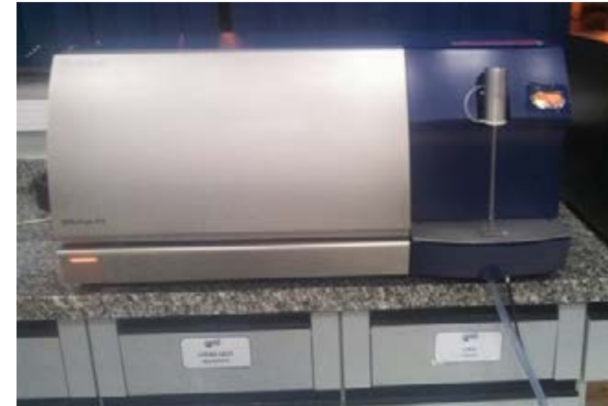
O aparelho da empresa Foss, o Milkoscan FT1, é similar aos encontrados na Clínica do Leite, que determinam a composição do alimento e o Escore de Autenticidade (EA)
