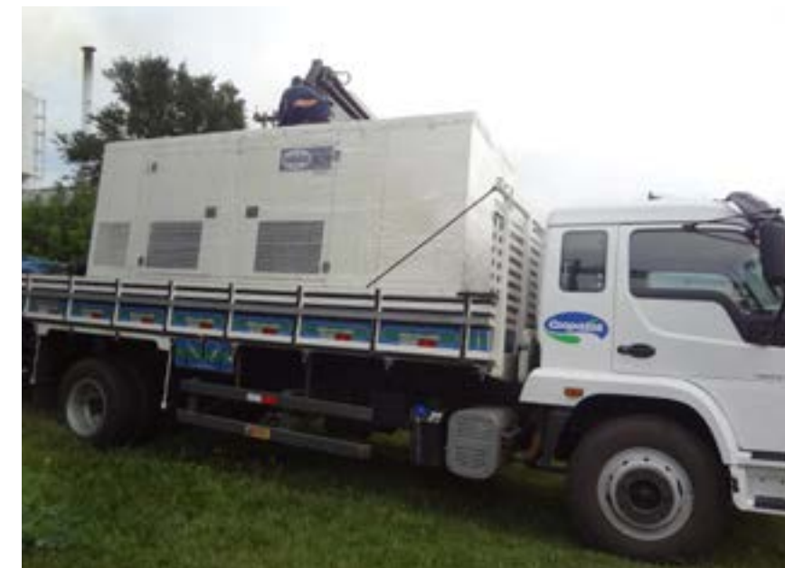
Cooperativa adquiriu um grupo gerador Caterpillar de 550 kVA, com partida de rampa (acionamento automático em caso de queda de energia), por cerca de R$ 250 mil
